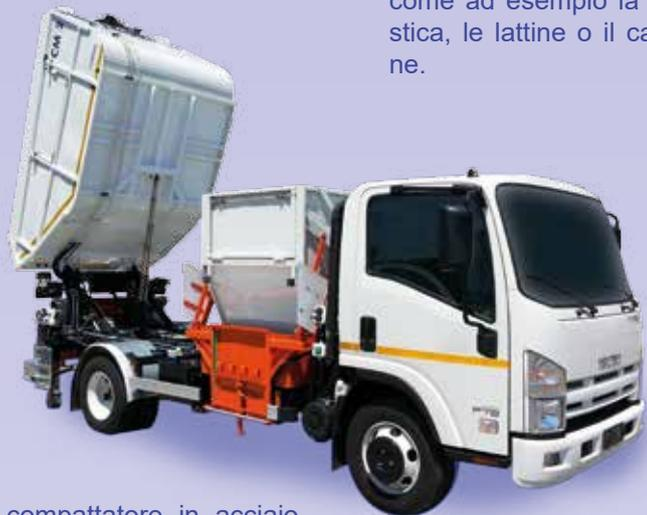
compattatore in acciaio INOX da 5 m<sup>3</sup>, capace di un rapporto di compressione 4:1 ribaltabile posteriormente (accoppiabile con compactatori più grandi) e di una vaschetta trasversale, sempre in acciaio INOX, da 2 m<sup>3</sup> ribaltabile lateralmente. Entrambe le vasche di raccolta sono dotate di attrezzatura volta-contenitori e stabilizzatori idraulici sincronizzati, nonché di uno specifico sportello per il ca-
