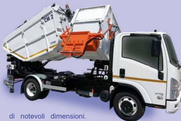
di notevoli dimensioni. La grande affidabilità è assicurata dal nostro collaudato gruppo oleodinamico integrato, in grado di gestire l'intero ciclo di compattazione senza l'ausilio di delicati componenti elettriche o elettroniche. Il particolare dispositivo di compattazione (lo stesso dei minicompattatori in alluminio serie rinforzata) è stato ulteriormente silenziato e garantisce il più alto rapporto di compressione della categoria (4:1).
