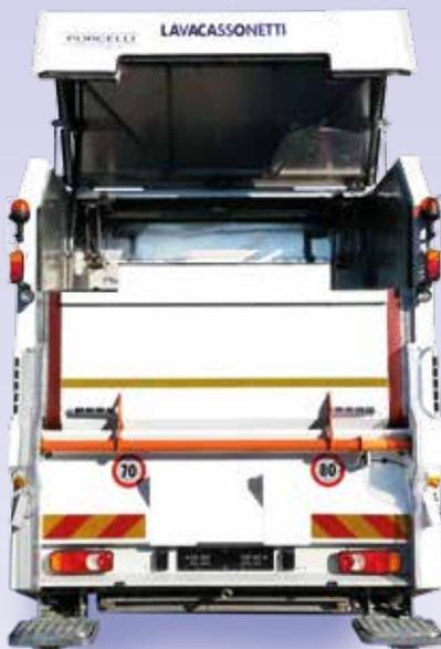
ne a chiusura ermetica e movimento pneumatico, permette di eseguire i lavaggi senza alcuna perdita di acqua.
